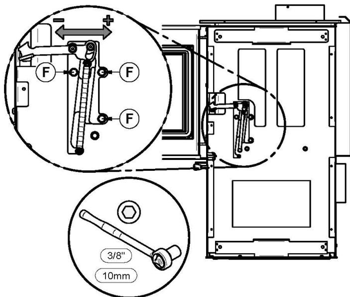
5. Ajuster le serrage de la porte en dévissant légèrement les boulons (F). Plus le mécanisme est éloigné de la porte, plus le serrage est fort.
