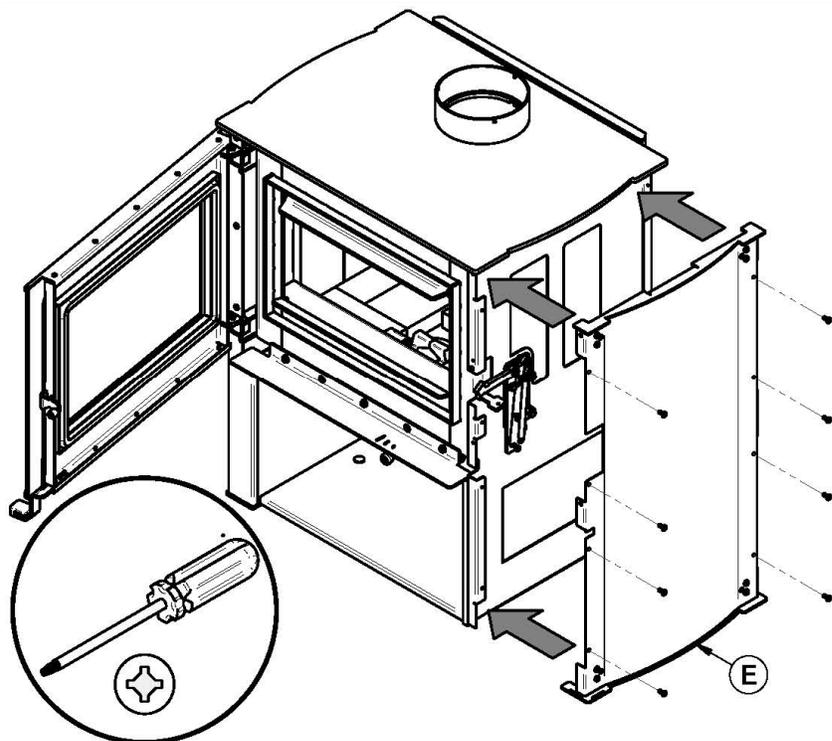
5- Réinstallez les colonnes (C) et (D)
