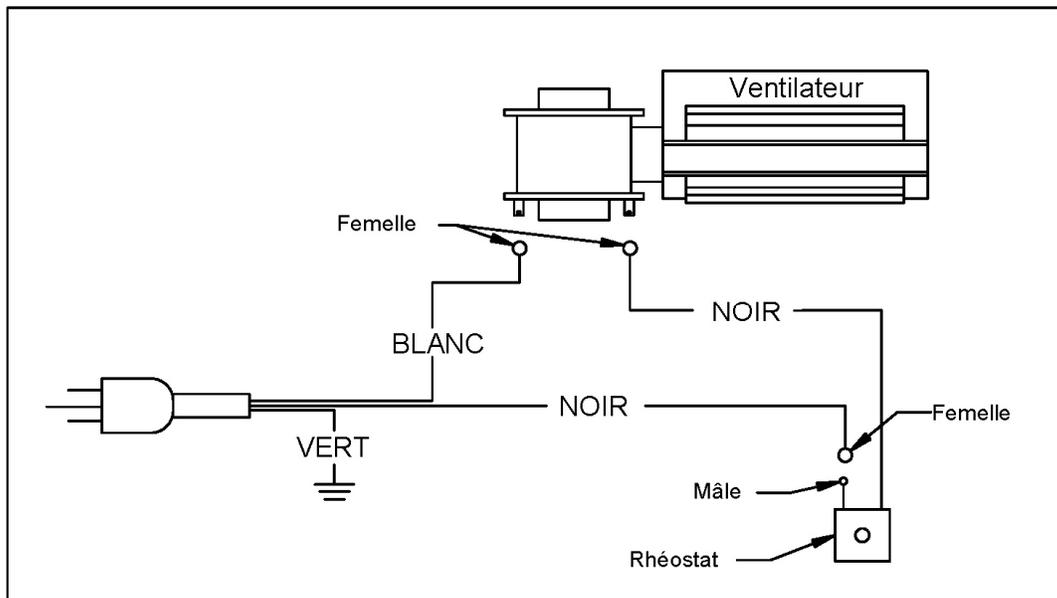
**AVERTISSEMENT : ASSUREZ-VOUS QUE LE CORDON ÉLECTRIQUE DU VENTILATEUR ET/OU DU THERMODISQUE NE TOUCHENT À AUCUNE SURFACE DU POÊLE DE FAÇON À ÉVITER LES DÉCHARGES ÉLECTRIQUES OU LES INCENDIES. NE FAITES PAS PASSER LE CORDON ÉLECTRIQUE SOUS LE POÊLE.**
