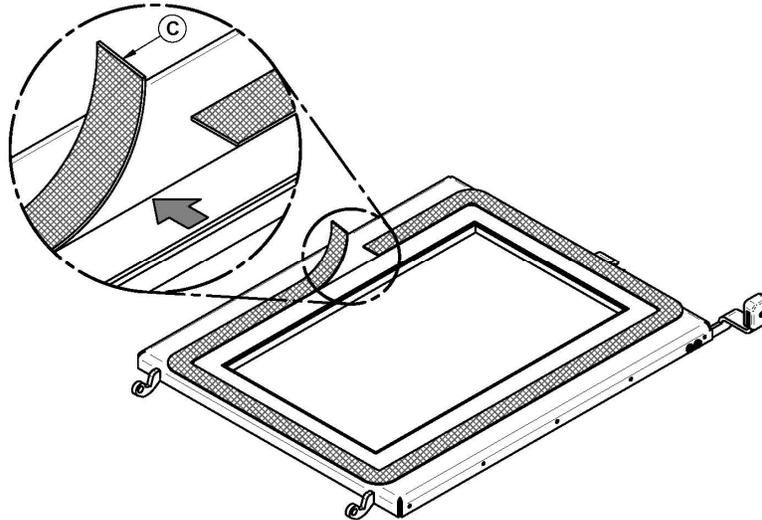
Remplacez la vitre, en prenant soin de bien centrer la vitre dans la porte. Ne pas trop serrer les vis. Remarquez que les deux principales causes de bris de vitre sont un positionnement inégal dans la porte et des vis de rétention trop serrées.
