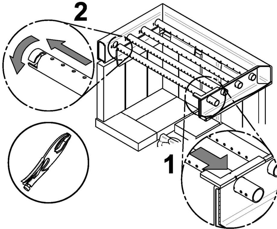
1. En commençant vers l'arrière, inclinez et insérez le tube d'air secondaire arrière dans le trou du fond de la canalisation droite (**DÉTAIL 1**). Ensuite, levez et poussez le tube vers la gauche dans le trou correspondant de la canalisation de gauche.
