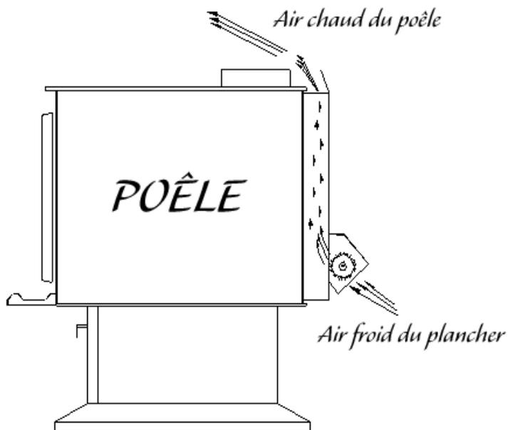
Il est également possible d'installer, sur votre appareil, le thermodisque # AC05530 (modèle de base inclus avec le ventilateur) qui permet au ventilateur de fonctionner seulement quand le poêle est assez chaud. Vous pouvez aussi installer le thermodisque à branchement éclair #AC02055, vendu séparément.
