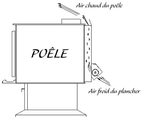
**AVERTISSEMENT : ASSUREZ-VOUS QUE LE CORDON ÉLECTRIQUE DU VENTILATEUR NE TOUCHE À AUCUNE SURFACE DU POÊLE DE FAÇON À ÉVITER LES DÉCHARGES ÉLECTRIQUES OU LES INCENDIES. NE FAITES PAS PASSER LE CORDON ÉLECTRIQUE SOUS LE POÊLE.**
