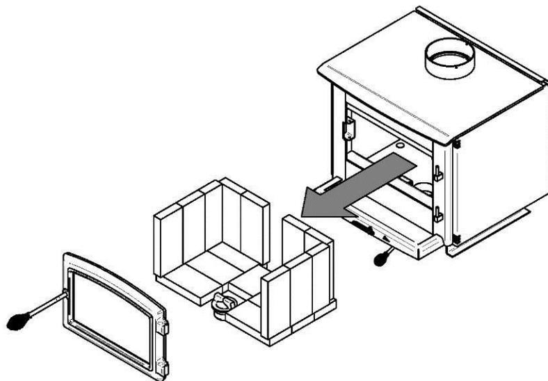
1- Retirez les briques, le bouchon à cendre pour éviter d'endommager des pièces et faciliter les manipulations dans les étapes suivantes.
