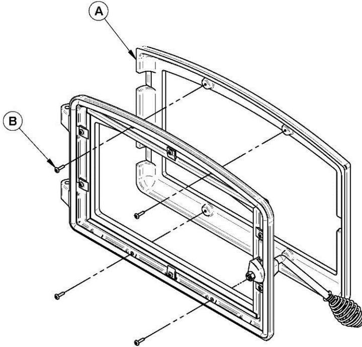
Positionnez le revêtement (A) sur la porte et fixez-le en place par derrière en utilisant les 4 vis (B) fournies avec ce dernier.
