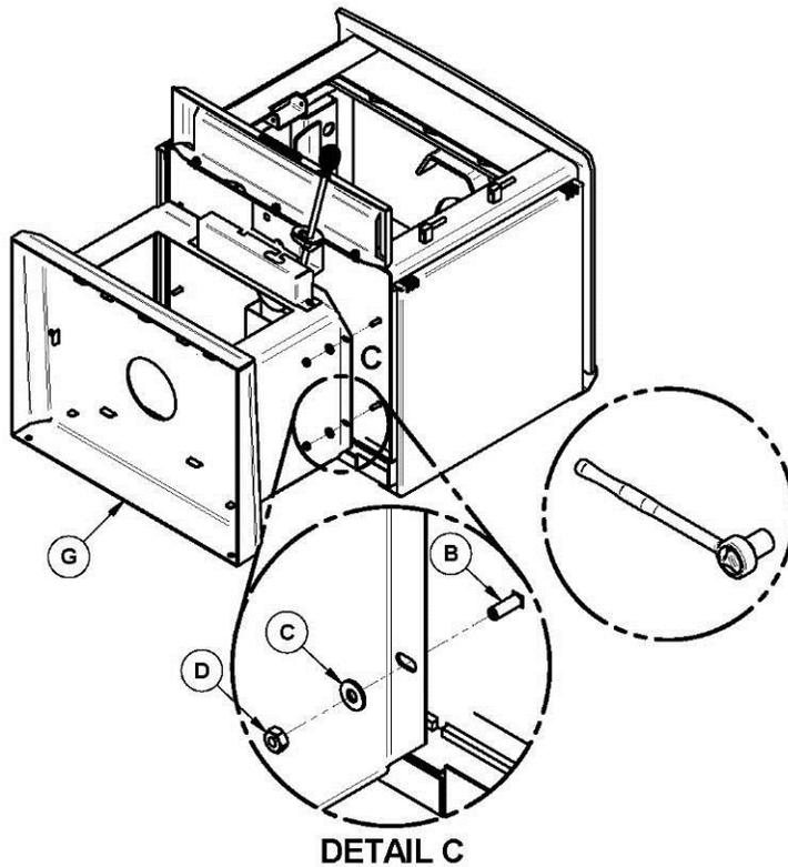
**Note :** Insérez chaque boulon de l'intérieur de la chambre à combustion, ce qui permettra aux briques de s'asseoir plus uniformément sur le plancher de celle-ci
