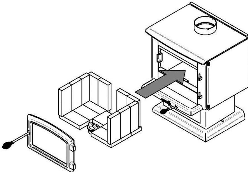
**Note :** Assurez-vous que les composantes du déflecteur n'ont pas bougés au cours du processus d'installation du piédestal puisqu'une obstruction du conduit de fumée pourrait se produire.
