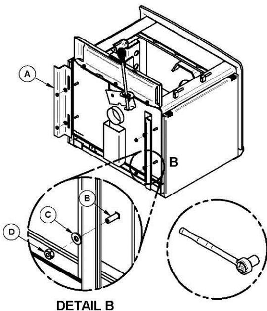
3- Dévissez les 4 écrous et rondelles pour enlever les 2 supports d'acier. Disposez des 2 supports d'acier car ils ne sont plus nécessaires. Conservez les boulons, les rondelles et les écrous puisqu'ils seront nécessaires à l'étape 5.
