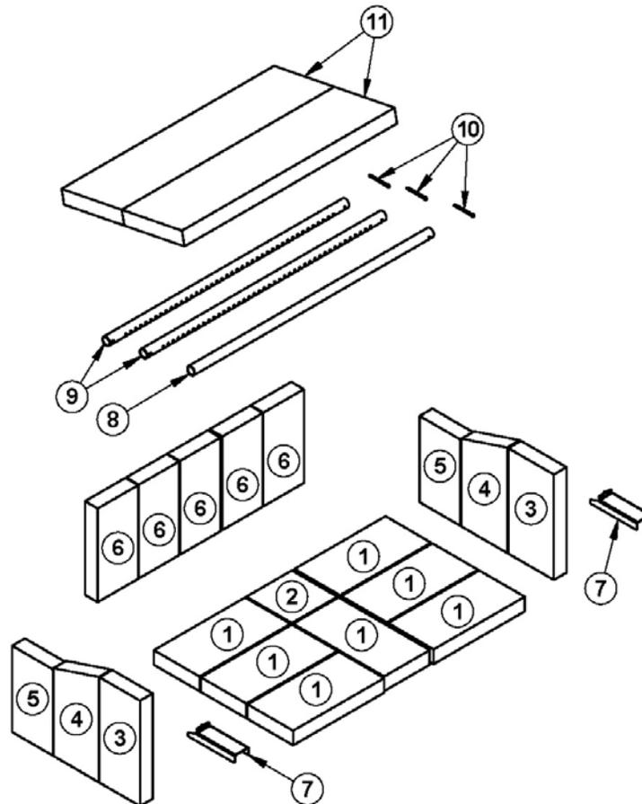
Figure 4.3 – Disposition des briques pour le modèle SOLUTION 2.0
